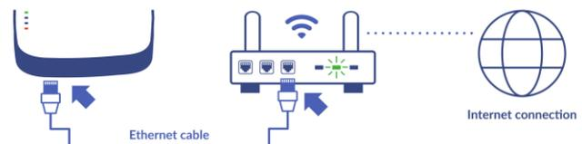
3. Wenn der nächstgelegene Zugangspunkt für eine Kabelverbindung zu weit entfernt ist, empfehlen wir, die Verbindung mit einem Powerline-Adapter, WiFi-Repeater oder mobilen Router zu überbrücken.
