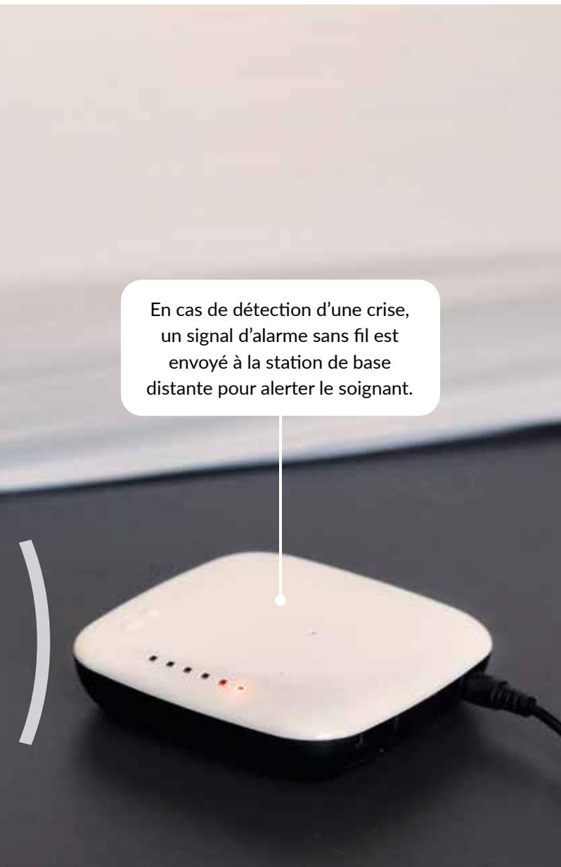
En cas de détection d'une crise, un signal d'alarme sans fil est envoyé à la station de base distante pour alerter le soignant.
